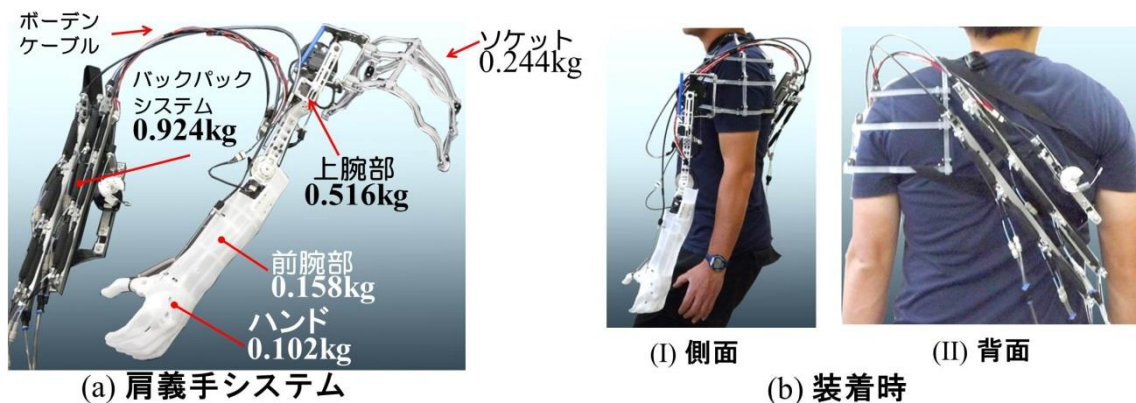
図 7-3. 5 自由度(モーター関節 4, PEA 拮抗関節 1)試作肩義手
