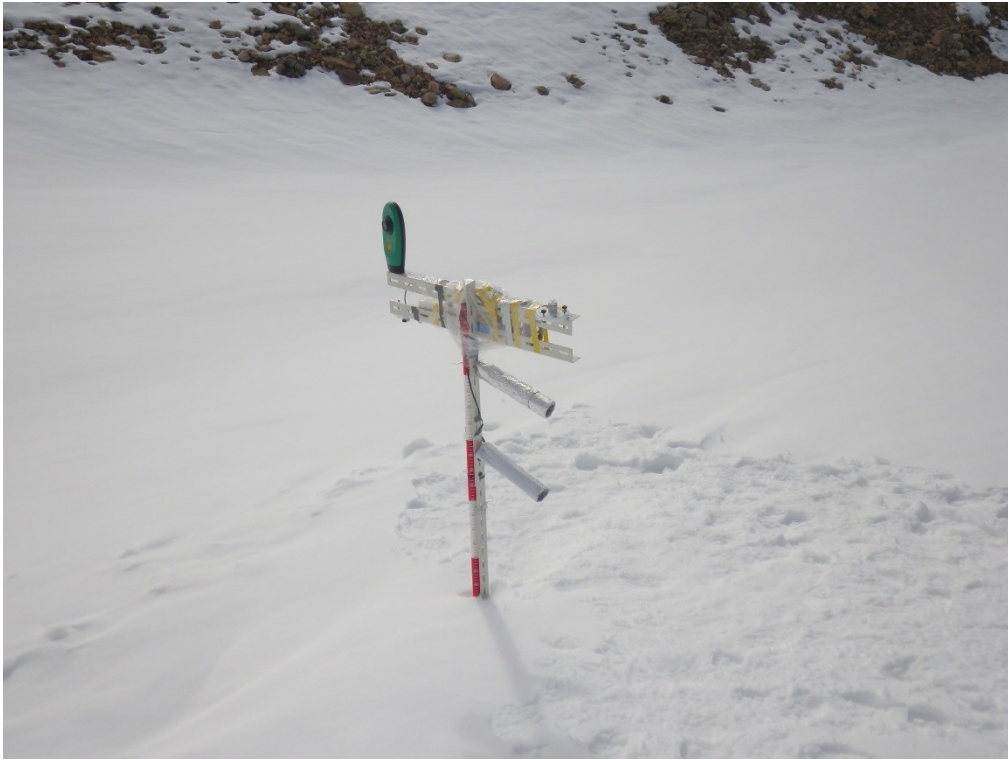
図 2-5. Site-A に設置した自動気象測器
