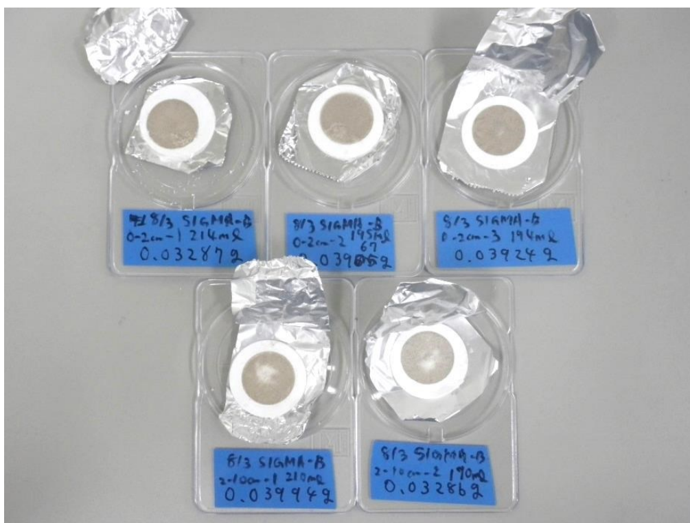
図 2-9. 石英ガラスフィルターに濾過した炭素分析用のサンプル。 撮影は 2014 年 9 月 3 日に気象研究所のクリーンルーム内で行った。
