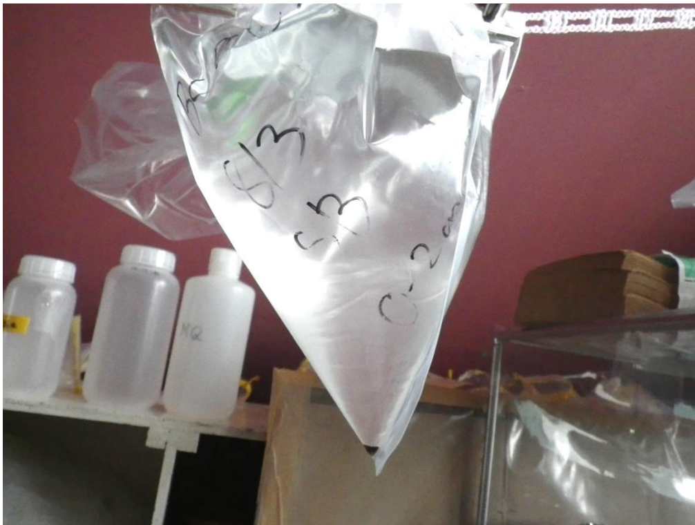
図 2-10. 鉍物分析用のサンプルの分析前処理の様子. ポリ袋の底に沈殿物が溜まっている.
