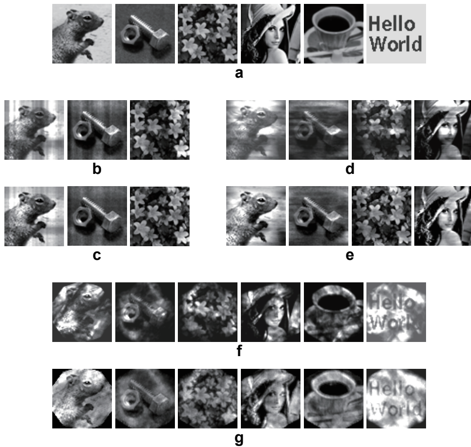
図 2.3: 投影画像の比較. (a) 表示させたい入力画像 (左から I_1 - I_6 ). 入力画像が 3 枚の場合の (b) オリジナル手法と (c) 画質改善手法. 4 枚の場合の (d) オリジナル手法と (e) 画質改善手法. 6 枚の場合の (f) オリジナル手法と (g) 画質改善手法.
