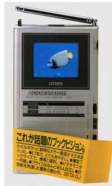
ネーミングも含めて担当したペーパーバックサイズのカラーテレビ。バックライト内蔵型のため、容積の半分は乾電池とバックライトが占めている。
