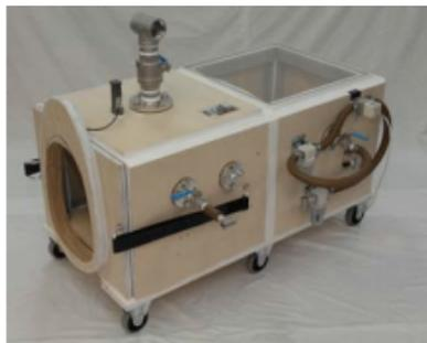
民生品を用いた電子制御型下半身陰圧装置の製作
