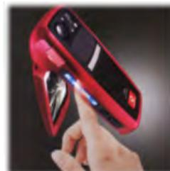
V401Dのインターフェースデザイン。業界初の指でなぞって操作する「コントロールパッド」を装備。画面のスクロールやカメラズーム操作、ショートカット操作を実現。
