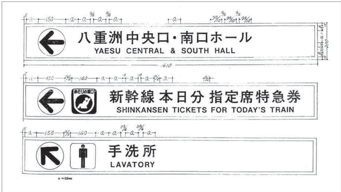
図 3-14 カラー掲示器の標準レイアウト (『電力と鉄道 1974年9月号』)
