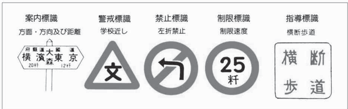
図 4-6 1942年の道路標識令(内務省令)による道路標識 (『95 道路標識ハンドブック』)
