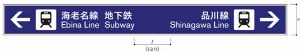
図 12-14 1表示面2方向指示のレイアウト例
