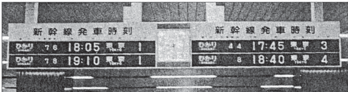
写真 3-23 フラップ式インジケータ (『電力と鉄道 1972年10月号』)
