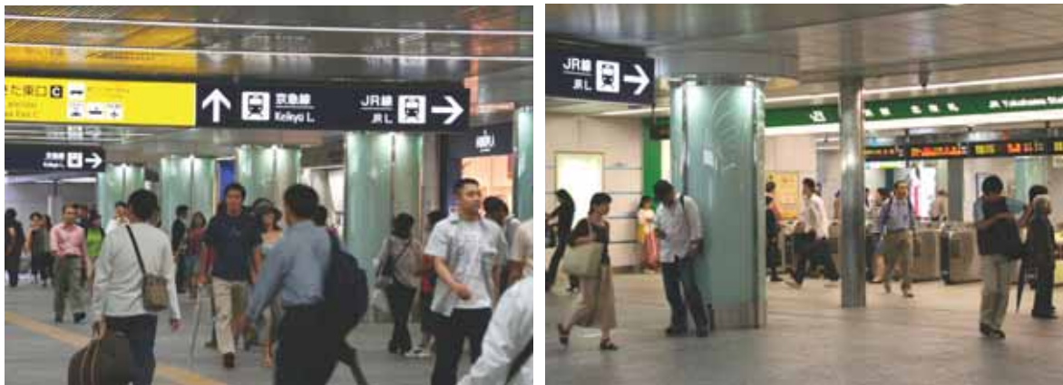
写真 10-9 ①道筋を明示する、左：通路上の指示サイン、右：右手奥の同定サインの例 (横浜駅きた通路、竣工 2004)
