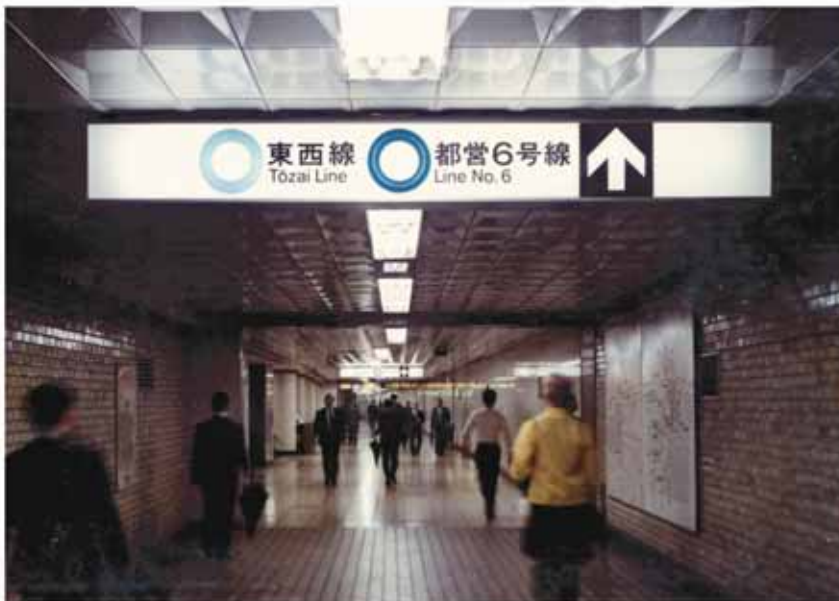
写真 6-25 路線色によるリング状のシンボルを導入したのりば誘導標
