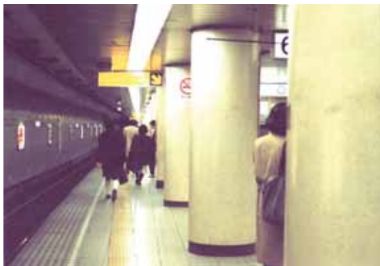
写真 11-7 営団地下鉄・表参道駅。独立柱によって、ホーム端部からは階段位置もわからない（筆者撮影 1982 頃）。
