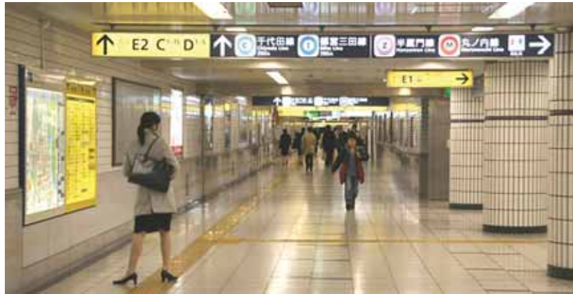
写真 12-24 情報満載のため指示方向の区別がつきにくいサインの例
