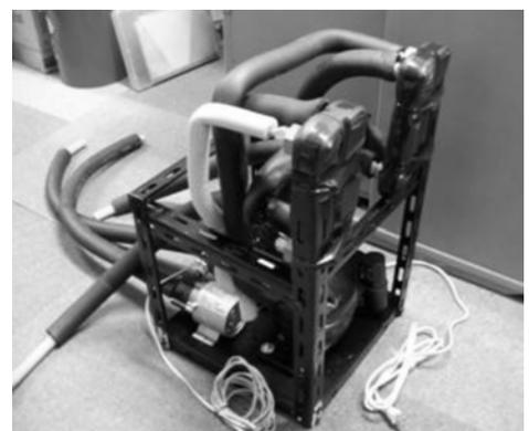
写真1-1 原理試作ヒートポンプ
