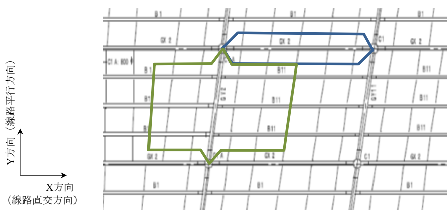
図 5.12 梁の支配面積の例
