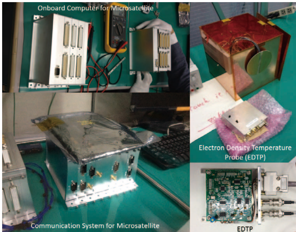
図 1.1.3-3 FPGA による GAIA-I 用のオンボードコンピュータ (OBC)、通信システム (CMS)、電子密度・電子温度プローブ (EDTP)
