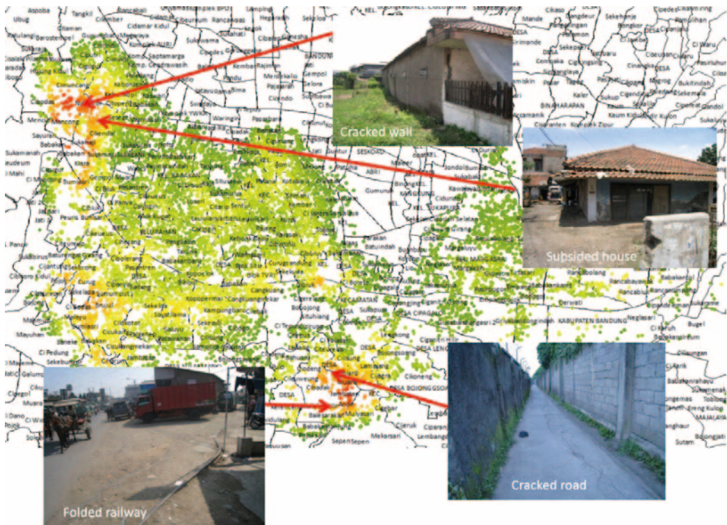
図 1.1.2-6 ALOS PALSAR PS-InSAR によるインドネシア・バンドン市内の地盤沈下の観測
