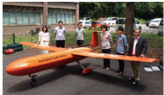
図 1.1.1-5 CP-SAR 搭載用 UAV JX-2
