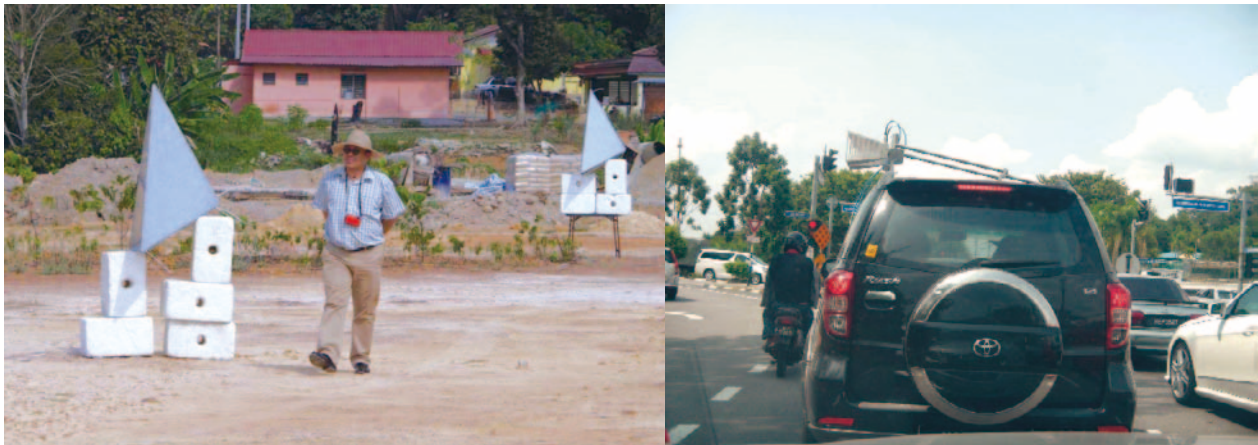
図 1.1.1.-7 マレーシア・マラッカ市内に実施した SAR センサのポイントターゲット (コーナリフレクター) による地上移動実証実験の様子
