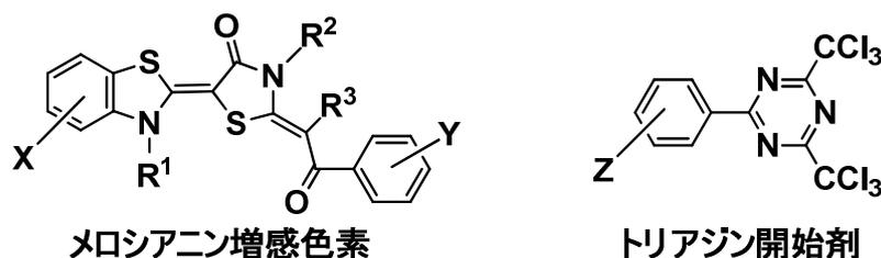
Fig. 2-1 488 nm レーザーに対応する開始系（プロトタイプ）
