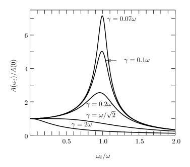
$\omega_f \approx \omega$  での  $A^2$  の近似的式を求めよう。 $\omega_f = \omega + \delta$  とし,  $\gamma, \delta \ll \omega$  のとき,  $\gamma$  と  $\delta$  の 2 次までで近似すると
