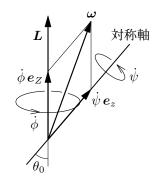
の大小関係で変わる。球対称こま (  $I_z=I_0$  ) の場合,  ${\bf L}=I_0 \omega$  になり自由回転は静止した軸 (  ${\bf L}$  ) まわりの一様な回転である。
