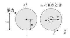
鉛直下向きの重力と平面からの鉛直上向きの抗力は運動に影響しないから考えない。剛体には水平面の接点で摩擦力 (F,0,0) が働くとする。剛体の接点の速度をuとすると, F は剛体と水平面の間に滑りがあるとき  $(u \neq 0)$ , 滑りをなくす方向に働くから
