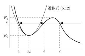
する。x=a でも同様であるから、質点は  $a\leq x\leq b$  の間で周期的運動をする。 $x\geq c$  の場合、初速度が v>0 ならば、質点は x 軸正方向に運動し続ける。逆に、初速度が v<0 ならば、質点は x=c に到着すると跳ね返り、x 軸正方向に走り去る。運動可能領域は E により異なる。上に述べた周期的運動は、 $E>E_1, E<E_0$  では存在しない。
