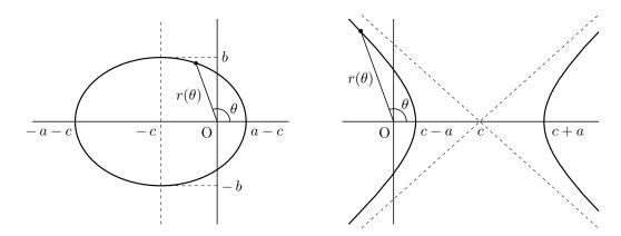
$0<\varepsilon<1$  であれば、惑星の運動は太陽を焦点の一つとする楕円軌道を描く。これはケプラーの第 1 法則である。惑星が楕円運動をしているとき、楕円の面積を面積速度 h/2 で割れば公転周期 T が求まる。楕円の長軸半径を a、短軸半径を b とする。 $b=\sqrt{a\ell}$  と  $h=\sqrt{\ell GM}$  を使うと
