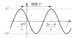
動数 (frequency),  $2\pi$  を掛けて角度で表した角速度  $\omega=2\pi\nu$  を角振動数 (angular frequency) ともいう。
