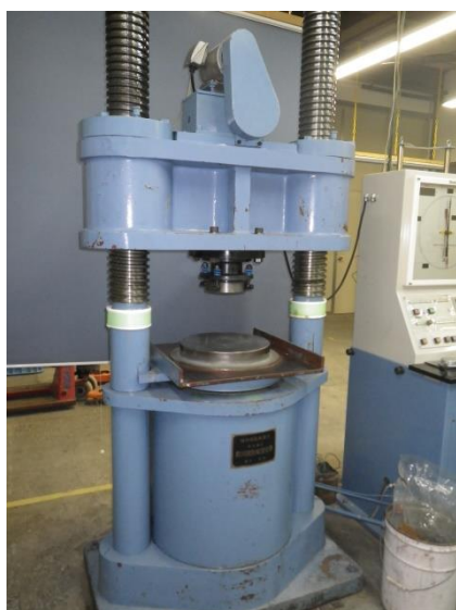
図 2.5 3000kN 全自動圧縮試験機
