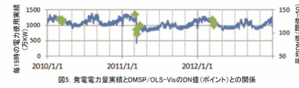
図5. 発電電力量実績とDMSP/OLS-VISのDN値(ポイント)との関係
