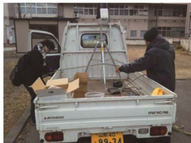
軽自動車に積載して移動させた気象観測ステーション
