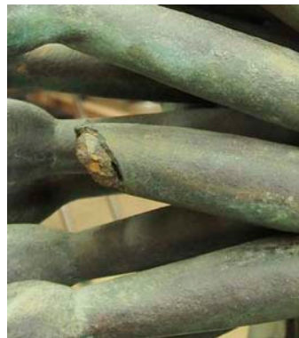
図7 破損して中子が見える部分（レプリカ後方から）
