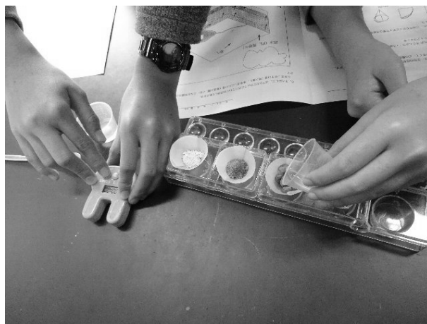
写真1 礫・砂・粘土の透水の違いを調べる実験
