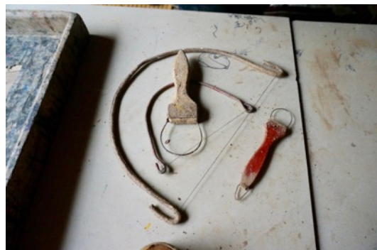
図1-32 泥を削るための弓状の道具
