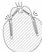
双音笛（手捏）の 断面図と発音・共鳴構造
