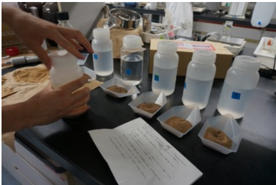
図 2-53 40g の風乾土を 500ml 容ポリビーカーに入れ 100ml のヘキサメタリン酸ナトリウム溶液と 300ml の蒸留水を加える様子
