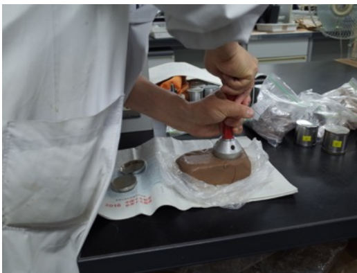
図 2-49 土壌三相計を用いて固相率と液相率の合計体積を測定する様子
