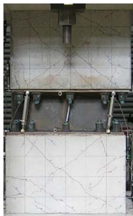
写真 4.2.3 No.3 試験体の加力状況 (3 回目, RC・S 複合間柱変形角 1/50rad)
