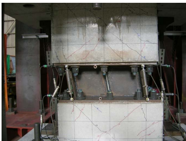
写真 4.4.3 ウェブ板交換後の載荷実験状況
