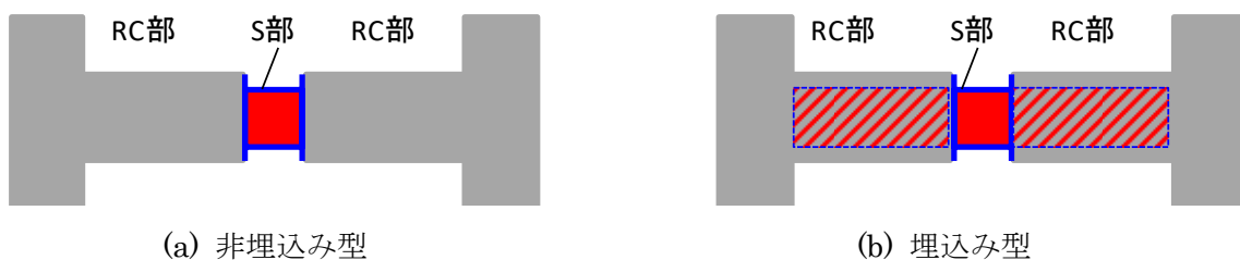
図 3.1.1 非埋込み型と埋込み型の RC・S 複合梁
