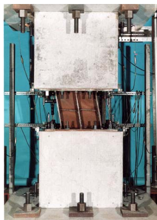
写真 4.2.2 No.2 試験体の加力状況(3 回目, RC・S 複合間柱変形角 1/50rad)
