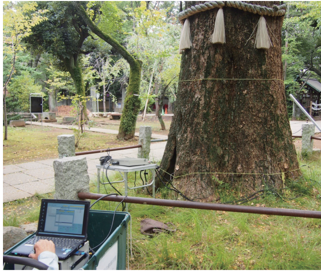
図 6-5 樹木診断機器ドクターウッズによる計測状況 (著者撮影)
