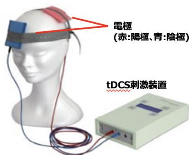
図2 tDCS 刺激装置と刺激による後シナプス電位の変動
