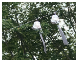
風灯：Solar ((有)Living World) 2005 回路設計 夜間の風の揺らぎ検出・増幅とLEDの平滑発光・太陽光パネルとキャパシタによる自己給電 Wind-lit: Solar 2005; Circuit design
