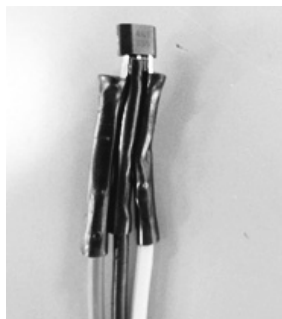
図5 磁界センサとその脚の保護
