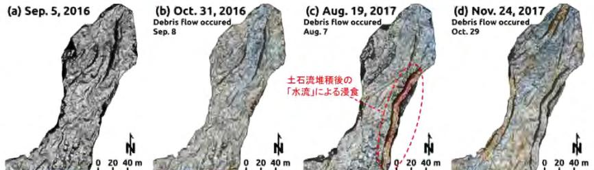
Fig. 4 土石流発生後の一ノ沢末端の土石流扇状地の地形変化
