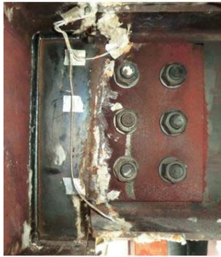
(a) 接合部の変形状況
