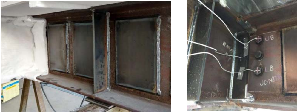
図 2.2.5 片持ち梁部の写真（左：ウェブのせん断補強鋼板，右：上下フランジ同士の溶接）
