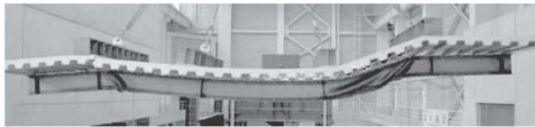
図 1.2.8 実験後の合成梁の損傷状況 1.17)
