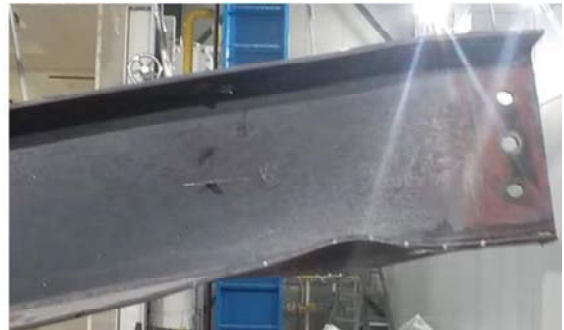
(c) 梁端の下フランジの局部座屈
