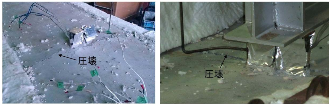
(b) 左側載荷点におけるスラブ上端の圧壊(左: 実験後, 右: 加熱開始後 30 分時)
