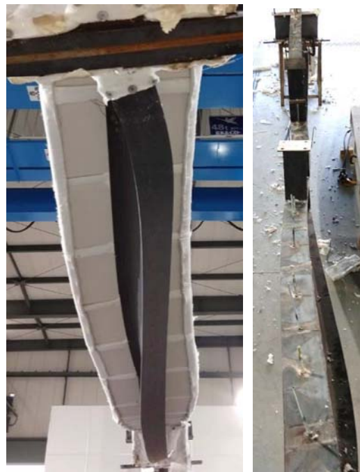
(e) 小梁の面外変形状況 (左: 下側, 右: 上側)
