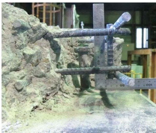
図 3.3.9 直交大梁上の頭付きスタッドの変形 (ウェブ接合梁 6UP)
