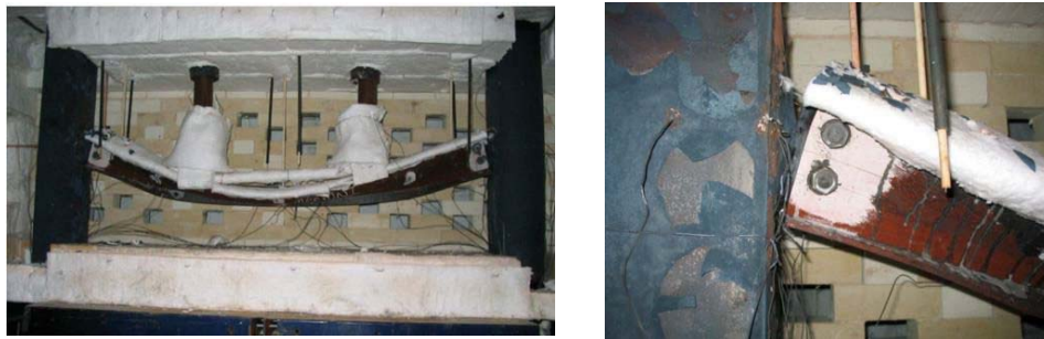
図 1.2.12 Fin-plate 接合を有する梁架構の実験後たわみ状況(左)と Fin-plate 接合部の損傷状況(右) 1.29)
