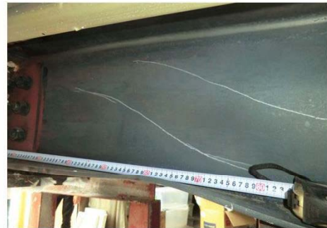
(c) 小梁端部の下フランジ局部座屈とウェブせん断座屈
