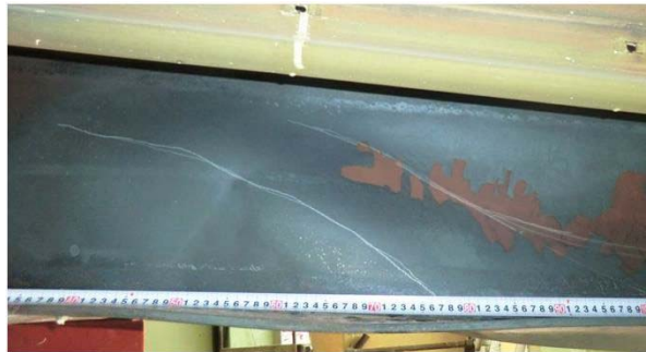
(c) 小梁端部の下フランジ局部座屈とウェブせん断座屈
