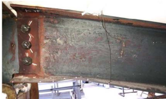
(c) 梁端の下フランジの局部座屈
