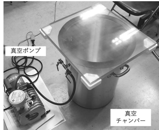
図9 自作真空チャンバーの外観
