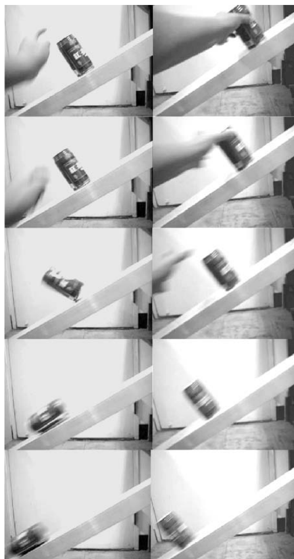
図1 アルミ製斜面上でのスチール缶の運動 左：転倒，右：滑走。
