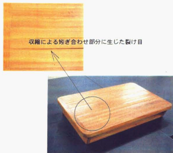
図6-6 端嵌をした甲板の矧ぎ合わせ部分の変形
