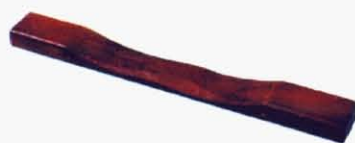
図6-23 えぐり加工により調律された音板裏面
