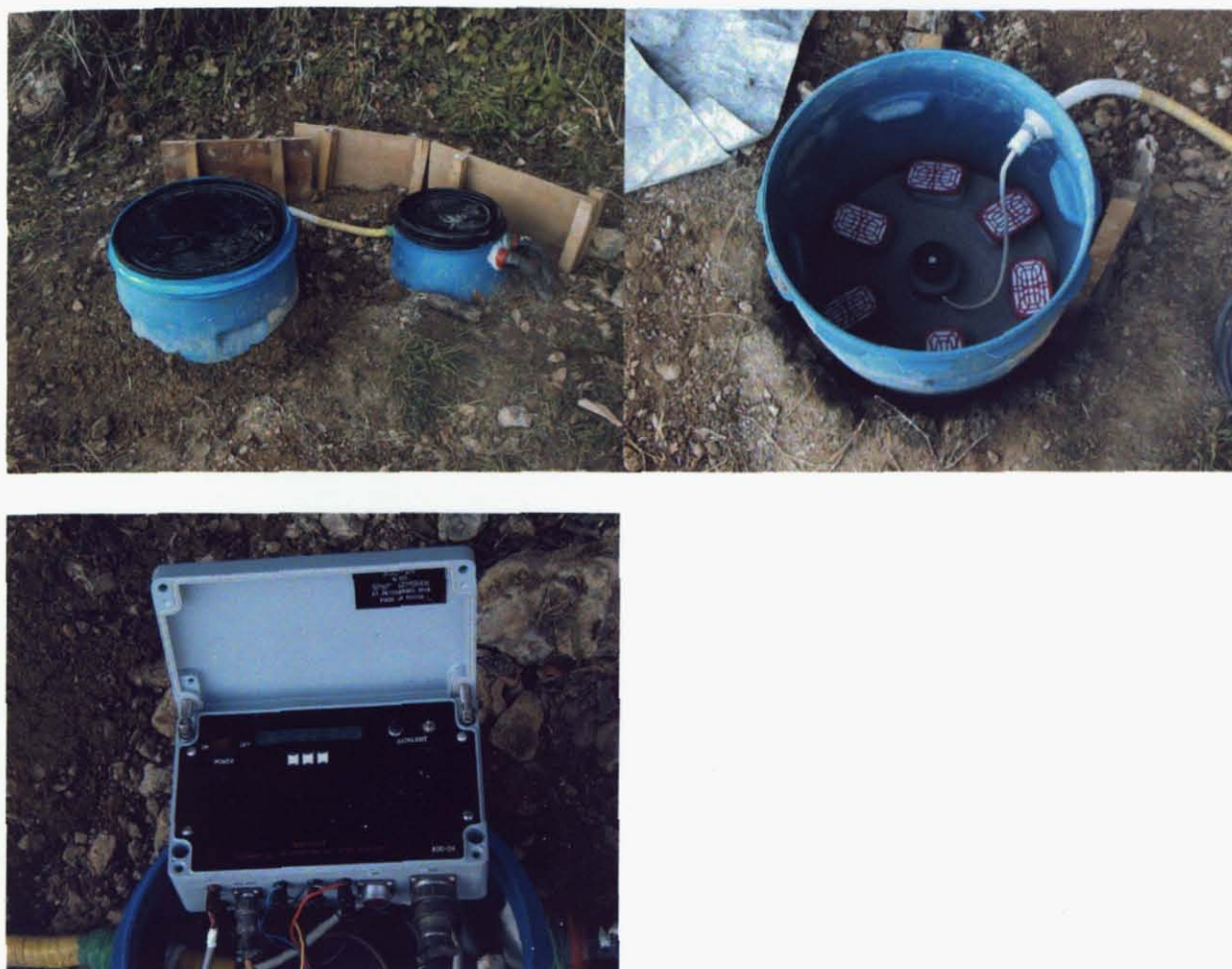
Fig.2.6 トーション型磁力計設置の様子。(a):センサーとADコンバータの収められたプラスチックボックス。防水、密閉性の高い化学工業用容器を使用している。(b):トーション型センサー。非鉄製の砂(珪砂)により固定されている。(c):ADコンバータ。センサー直近でデジタル変換され観測小屋まで送信される。
