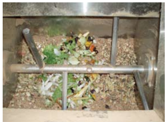
生ごみ処理機内部
