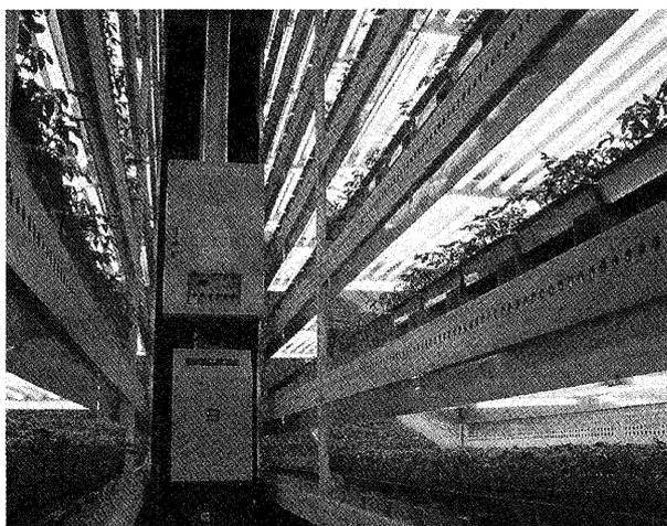
第3図 閉鎖型植物生産システムの一例。ここでは、光に不透明な断熱壁に覆われたほぼ閉鎖された空間内で、人工光源を用いて植物を育成する。
