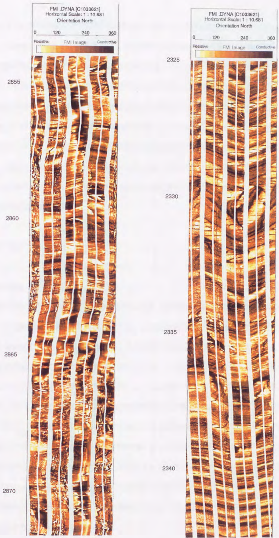
図1-8：基礎試錐「夕張」のFMI検層から得られた割れ目の画像 (左図) 天然フラクチャーの割れ目, (右図) 層理面の開口, 数値は深度 (m) を示す。
