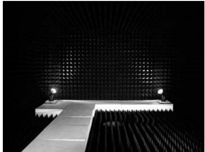
図 マイクロ波リモートセンシング研究用電波無響室
