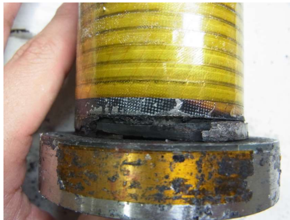
図1.24 焼損したレイヤー巻 REBCO コイル[1.59]
