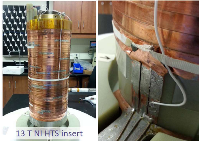
図3.1 13 T NI パンケーキ巻 REBCO コイルと外層 6 T LTS コイルクエンチ後のコイルの損傷[3.6]
