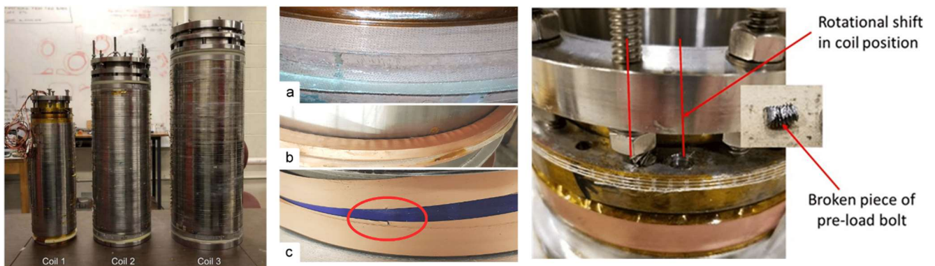
図3.2 18 T NI パンケーキ巻 REBCO コイル[3.8]と 17.9 T クエンチ後のコイルの損傷[3.7]
