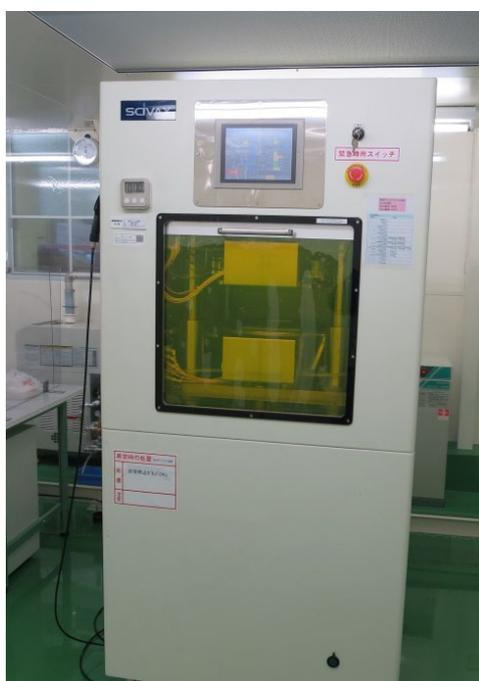
Fig. 2-2 熱ナノインプリント装置の外観
