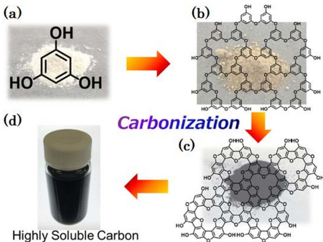
図 15 熱処理後の PG および理想的な脱水および炭素化生成物の構造。(a) PG の構造と外観、(b) PG473 の外観と理想的な脱水構造、(c) PG523 の外観と理想的な炭素化構造、(d) PG 573 の NMP 溶液 (1 重量%)
