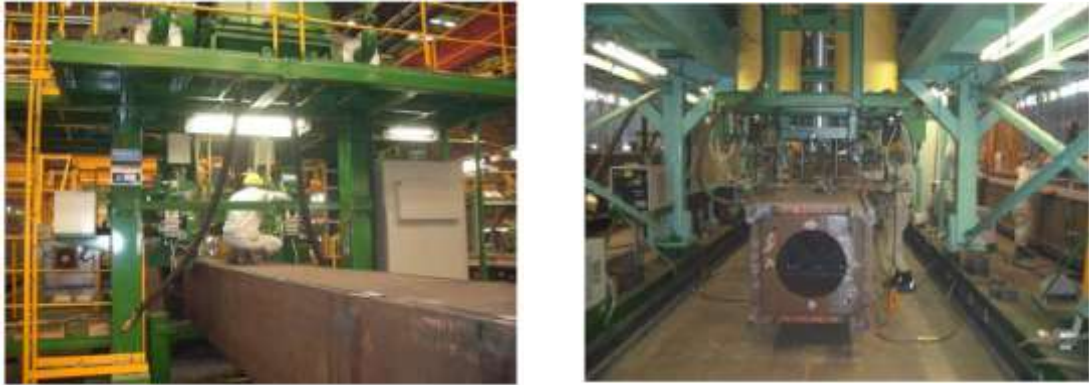
図 1.4 最新の SAW 溶接設備と ESW 溶接設備 [3]
