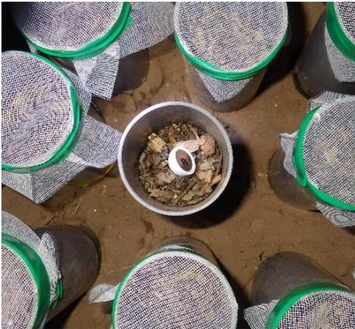
写真 26 チップ内温度の測定の様子
