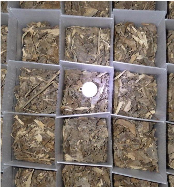
写真 23 チップ内温度の測定
