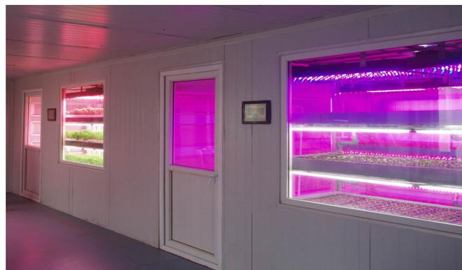
中国・農業科学院(北京)に2009年に楊基長氏らにより設置された、床面積100 m<sup>2</sup>の人工光(LED)型植物工場
