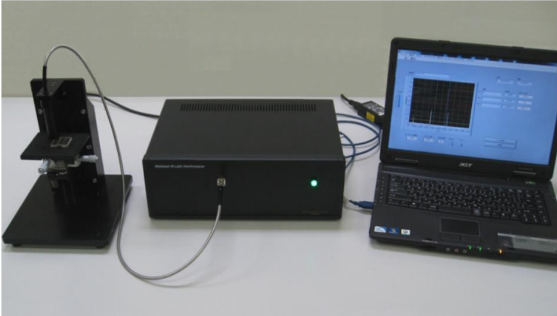
図 2.5 TD-OCT を用いた OCT 厚さ測定センサー(日本イリセン社製)
