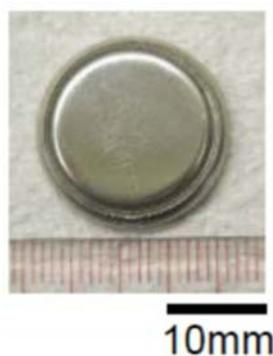
Fig.5-1 コイン型電池の外観図
