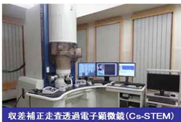
Fig.4-9 Cs-corrected STEM 外観写真 JEOL社製 JEM-ARM200F
