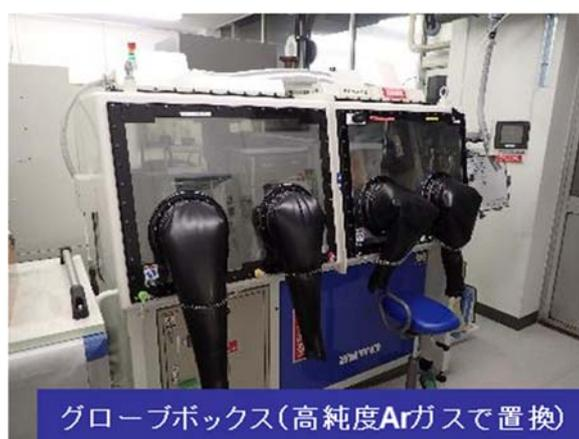
Fig.3-9 グローブボックス外観写真
