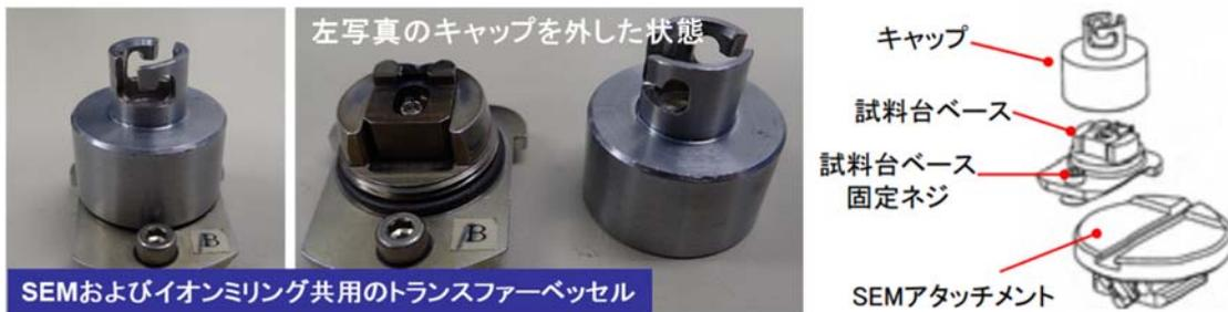
Fig.4-23 SEM およびイオンミリング装置用のトランスファベッセル(同じメーカー製の装置を移送する場合には共用できる構造としている)
