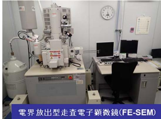
Fig.4-1 FE-SEM 外観写真 日立ハイテク社製 S-4800
