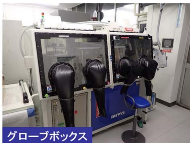
Fig.4-26 グローブボックス外観写真 美和製作所社製 パージ式グローブボックス
