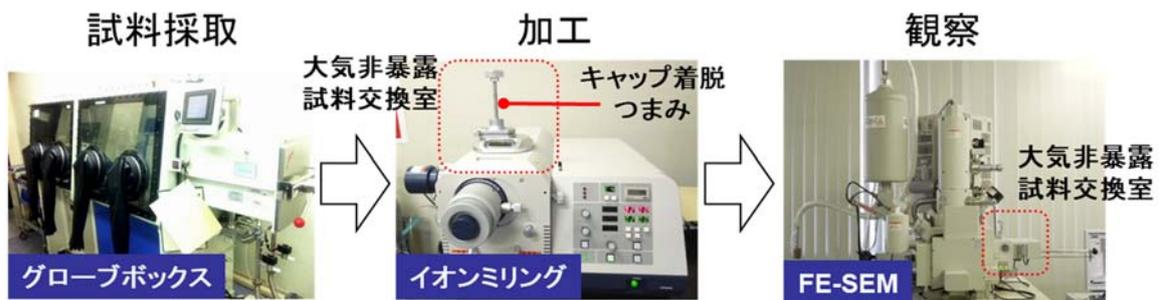
Fig.4-24 試料採取から SEM 観察までの流れ
