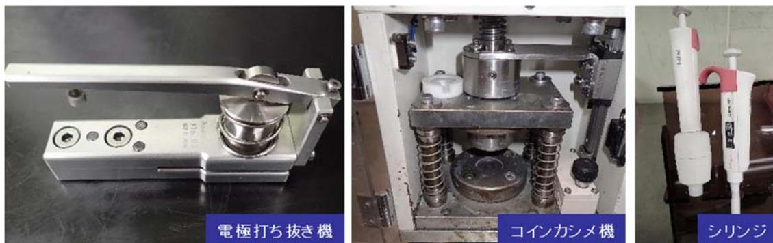
Fig.3-10 コイン電池の組み立てに使用した器具
