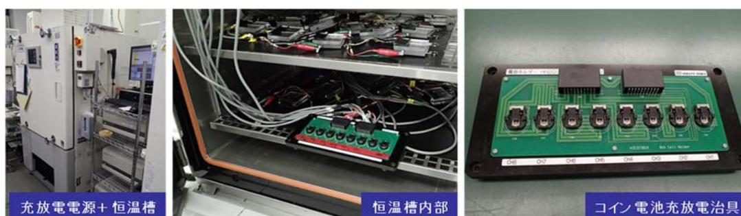
Fig.3-11 充放電試験装置
