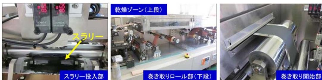
Fig.3-7 連続塗工機のスラリー投入から電極巻き取りまでの拡大
