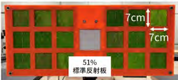
個葉の反射率とLWCの関係 (LiDARで計測)
