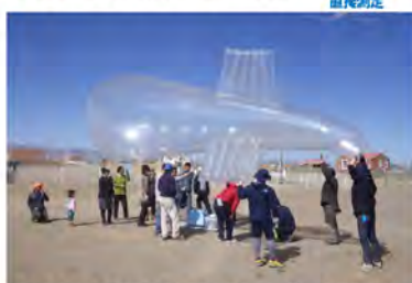
金沢大学の牧先生、岐阜学園大学の能田先生らと共に、係留気球によるバイオエアロゾル・ダスト粒径分布の観測。ダランザドガド気象台にて。
