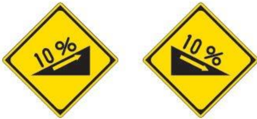
図 5-3 運転者に向け道路標識—急勾配あり標識 出所: 道路局
