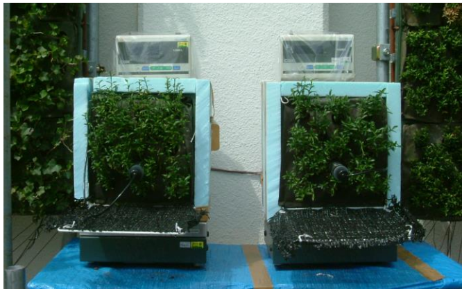
写真 3.2 電子秤を使用した蒸発散量の計測状況
