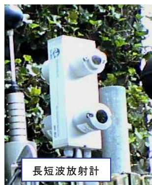
写真 3.3 気象要因(左)と長短波放射量(右)の計測状況
