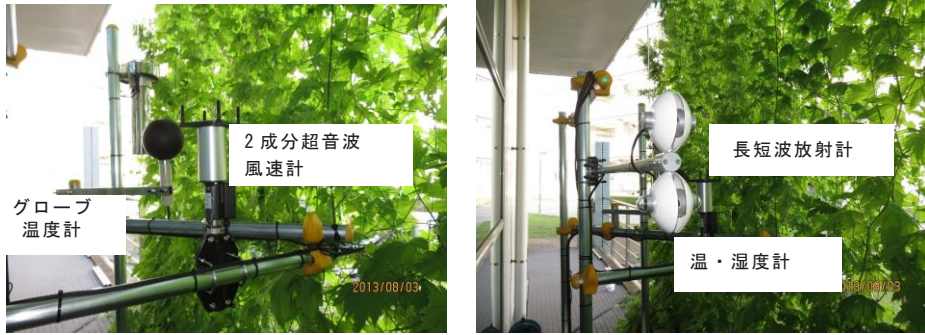
写真 4.6 一階の計測器設置状況（カーテン裏側）
