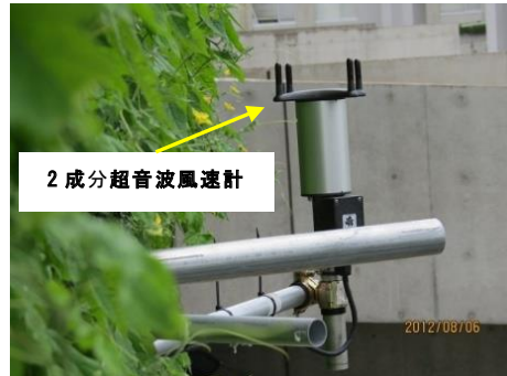
写真 4.12 G2 棟の計測器設置状況
