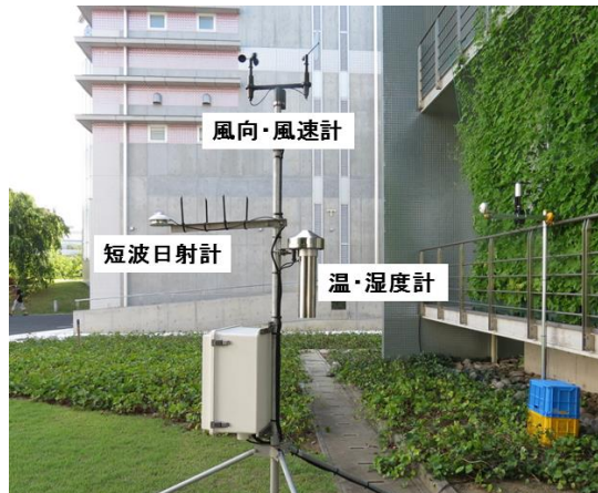
写真 4.2 気象条件の測定機器設置状況
