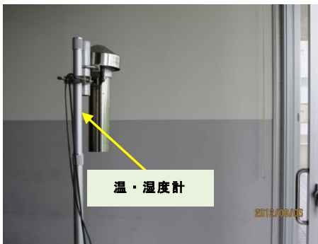
写真 4.13 G1, G2 棟教室内に設置した計測器
