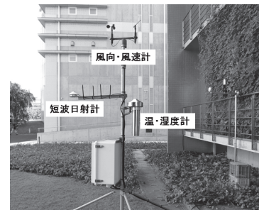
写真-2 気象条件の測定機器設置状況
