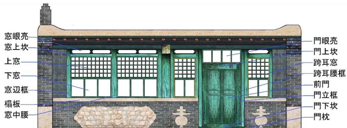
図 2-30 門と窓の木構造
