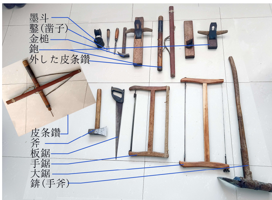
図 2-10 骨組み部材の準備用の木匠の道具
