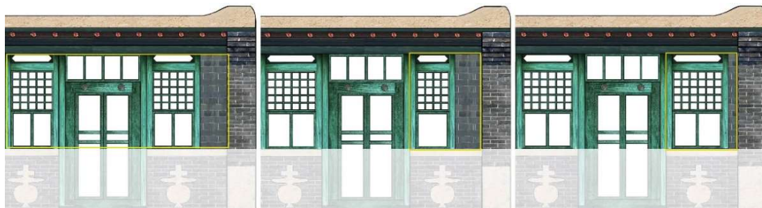
図 1-24 口袋屋の外屋の窓と壁垛の様子(黄色い枠)
