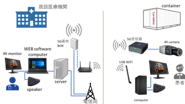
図 4-3-15：移動通信システム、公衆網を通じ無線接続
