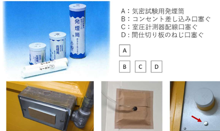
図 4-3-22：気密実験のため、予備スリーブ塞ぐ
