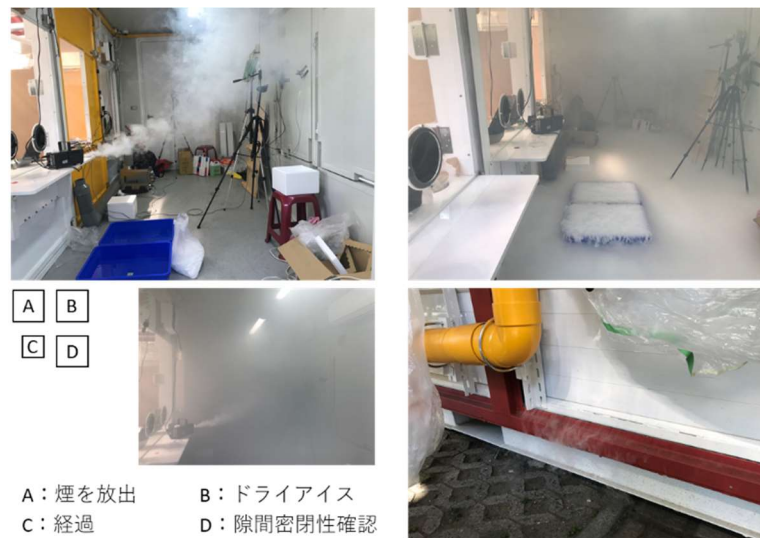
図 4-3-23：密閉性確認実験
