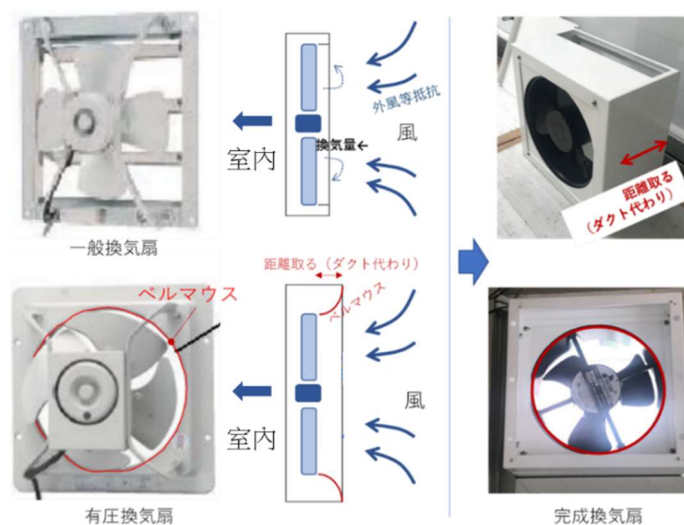
図 4-3-7：一般換気扇により室圧を作る
