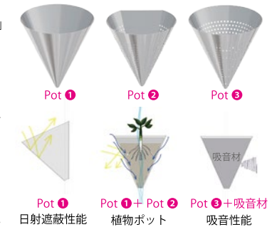
Pot 1 日射遮蔽性能 Pot 1 + Pot 2 植物ポット Pot 3 + 吸音材 吸音性能
