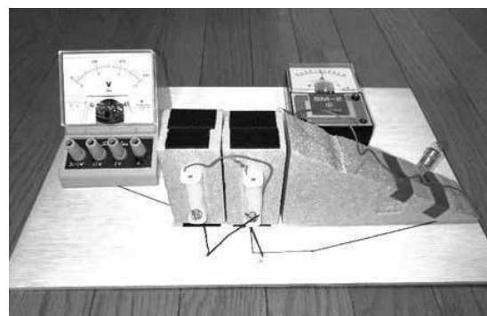
図4 電池が並列接続の実験教材
